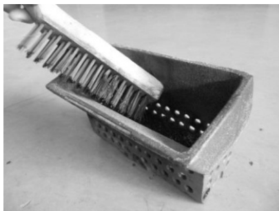
Figura 31 - Limpeza do cesto de queima
