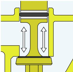
Na figura é visível que a força exercida na sede é contrabalançada pela força criada pela pressão, que actua no pistão de compensação. Dado que este último tem uma superfície igual à do obturador, as duas forças anulam-se.
