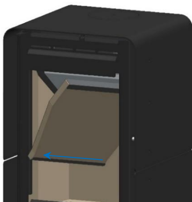
Figura 44 - Sequência que deve ser seguida para retirar o deflector de fumos
